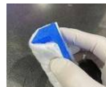
平面・多面積には当て板スポンジに三つ折りクロスを巻いて使用
